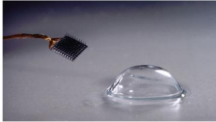
Fig. 3. Image of electrodes array [28]
