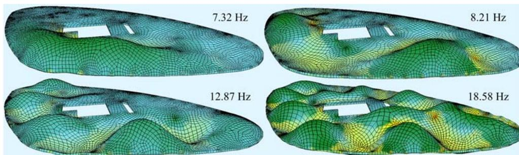
Fig. 6. Eigenmodes
