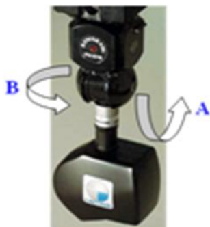
Fig. 4.1.4 Exemplu de orientare a capului de scanare cu LASER, după cele două unghiuri de rotație, în cele două plane [1]
