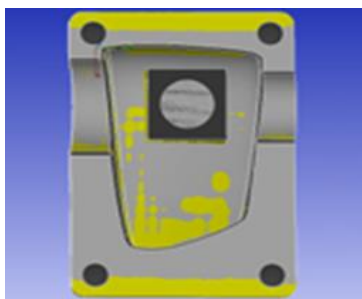
Fig. 4.1.20 Alinierea modelelor, în vederea comparației
