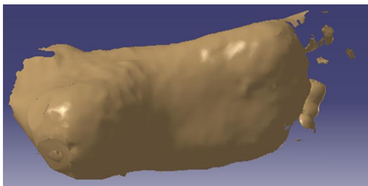
Fig. 4.2.14 Generarea modelului CAD în urma operației de umplere a găurilor [47], [110]
