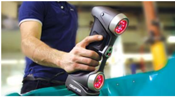
Fig. 5.1.2 Manevrarea scannerului HandyScan3D, pentru numerizarea unei caroserii auto [113]
