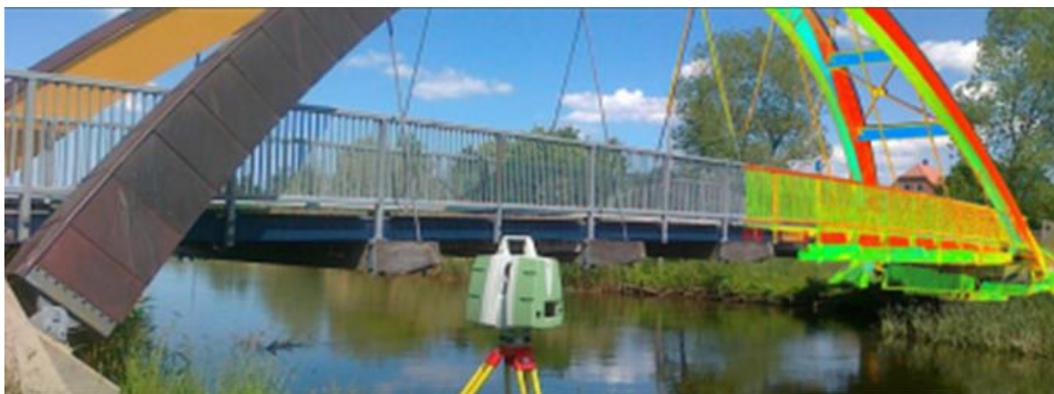
Fig. 5.1.11 Utilizarea sistemului LASER Scan: a) la scanarea încăperilor; b) la cartarea structurilor de tip pod sau pasarelă [117]
