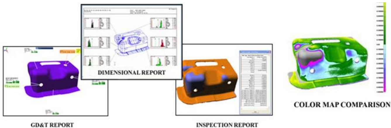
Fig. 5.2.3 Suprapunerea modelului CAD peste harta de comparație și generarea rapoartelor inspecției dimensionale, în cazul numerizării unui reper de tip carcasă [118]
