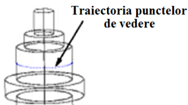
Fig. 3.5.2 Traiectoria punctelor de vedere proiectate în cazul numerizării unei suprafețe cilindrice [1], [86]
