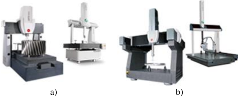
Fig. 2.4.17 CMM de dimensiuni mici și medii comercializate de compania HEXAGON Metrology : a) de dimensiuni mici și medii; b) de dimensiuni mari [71]
