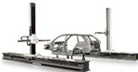
Fig. 2.4.18 MMC cu brațe orizontale, utilizate în industria auto [71]
