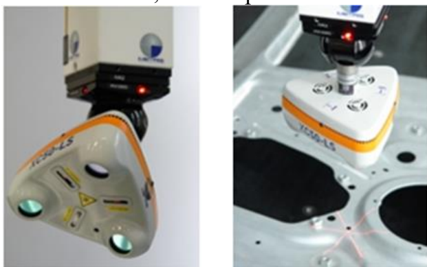
Fig. 2.2.6 Utilizarea captoarelor din seria XC 50 LS pentru scanarea caroseriilor auto [37]
