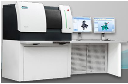
Fig. 2.4.38 Exemplu de model exaCT de tomograf computerizat, produse și comercializate de compania WENZEL [73]
