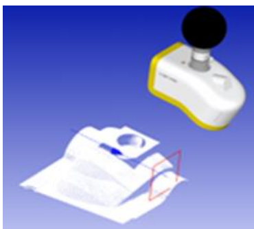
Fig. 4.1.17 Digitizarea unui reper de tip carcasă, cu obținerea modelului virtual al reperului [1], [105]
