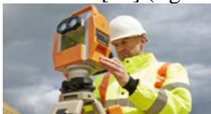
Fig. 2.4.12 Sisteme dedicate măsurărilor spațiale, pe principiul emisiai radiației LASER [70]
