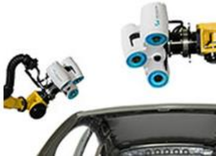
Fig. 2.4.14 Exemplu de automatizare pentru inspecția caroseriilor auto [71]
