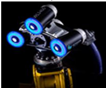
Fig. 2.4.28 Sistem de scanare cu sursă LASER, în lumină albă [71]
