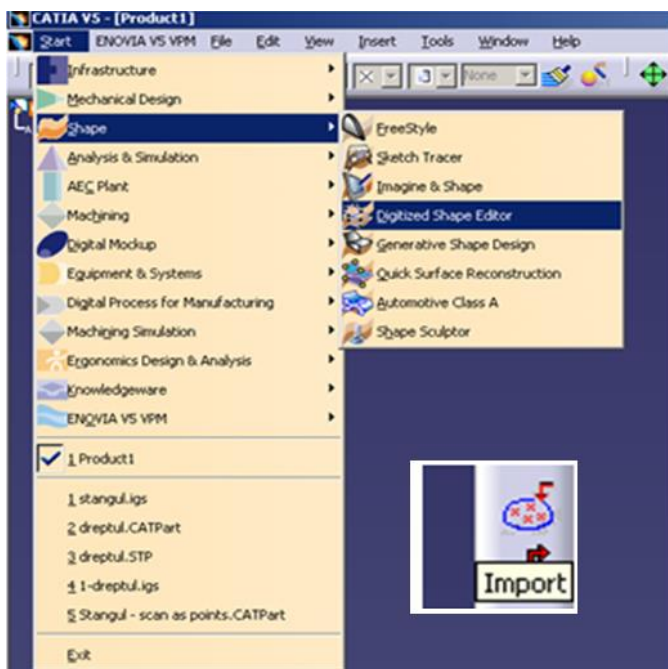
Fig. 4.2.11 Importarea unui model scanat anterior în mediul software de modelare CATIA [47], [110]
