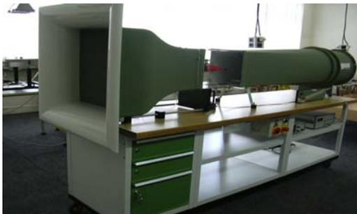
Fig. 3. *The wind tunnel HM170 Educational Wind Tunnel. G.U.N.T. Gerätebau GmbH. Barsbüttel, Germany [14]*
