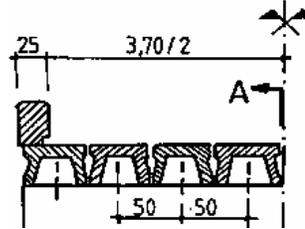
Fig. 1.  $\Pi$ -Beam Deck
